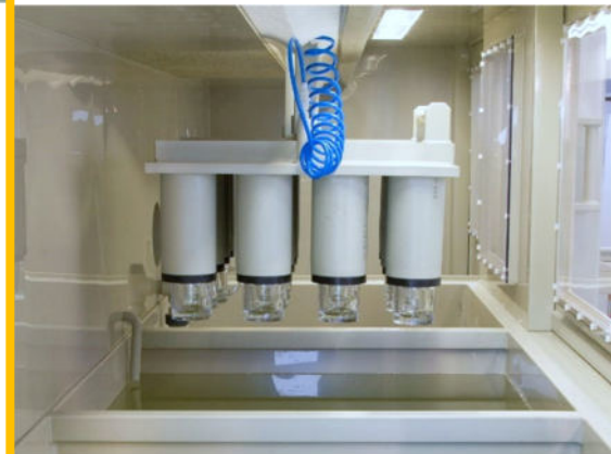
Mattieranlage für Glasartikel | Frosting system for glass items
